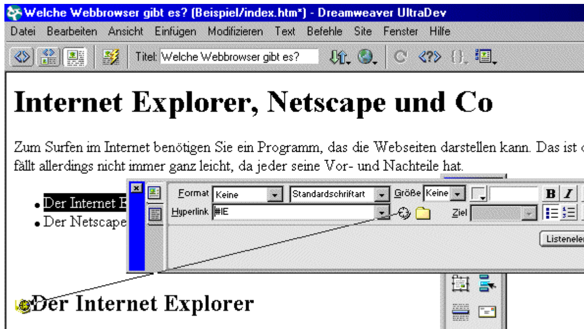
Abbildung 10: Erzeugen eines Hyperlinks auf einen Anker
